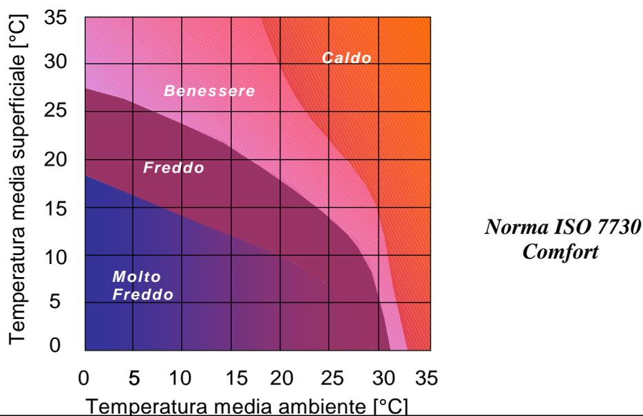
**Strategie di riferimento:** Al fine del mantenimento della temperatura dell'aria in condizioni di comfort senza eccessive variazioni nello spazio e nel tempo, con il minimo utilizzo delle risorse energetiche, è necessario che il sistema edificio-impianto risulti ottimizzato. Le principali strategie di ottimizzazione progettuale che si possono adottare per mantenere la temperatura di benessere, si possono riassumere come segue:
