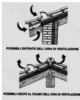
STRATIGRAFIA DI COPERTURA VENTILATA
