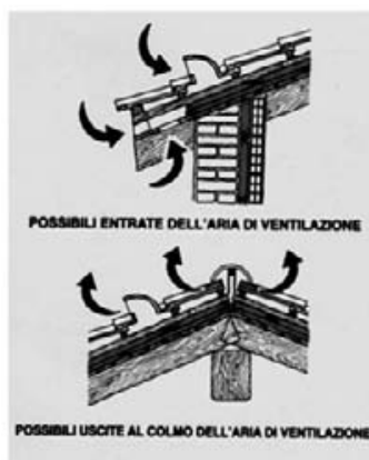
STRATIGRAFIA DI COPERTURA VENTILATA
