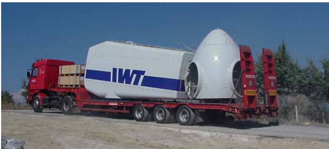
Fig.3.1 – Trasporto navicella, mozzo e altri accessori
