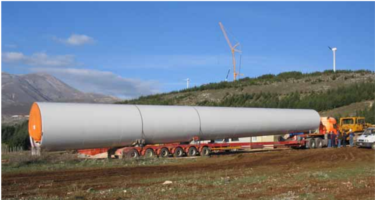
Fig.3.12 – Concio di torre su mezzo eccezionale allungabile
