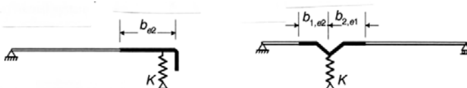
Figura C4.2.31 – Schematizzazione degli irrigidimenti
