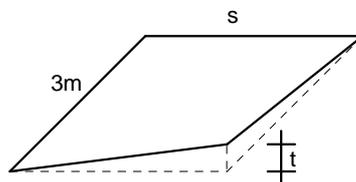
Figura 5.2.14 - Sghembo ammissibile
