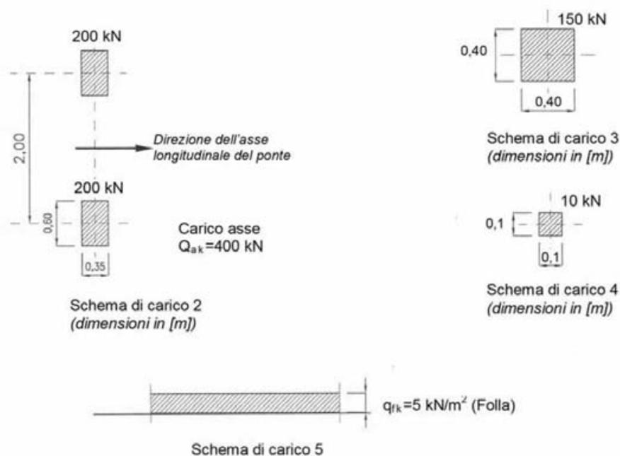
**Figura 5.1.2 - Schemi di Carico 1-5 Dimensioni in [m]**
