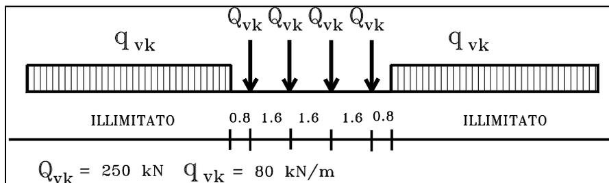
**Figura 5.2.1 - Treno di carico LM 71**
