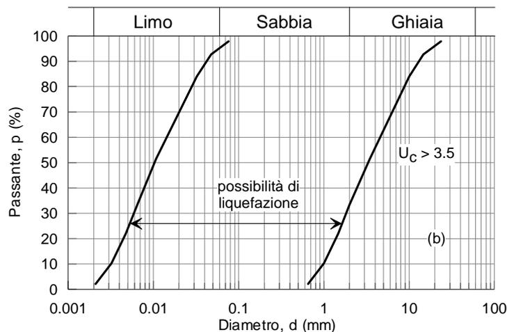
**Figura 7.11.1** – Fusi granulometrici di terreni suscettibili di liquefazione.
