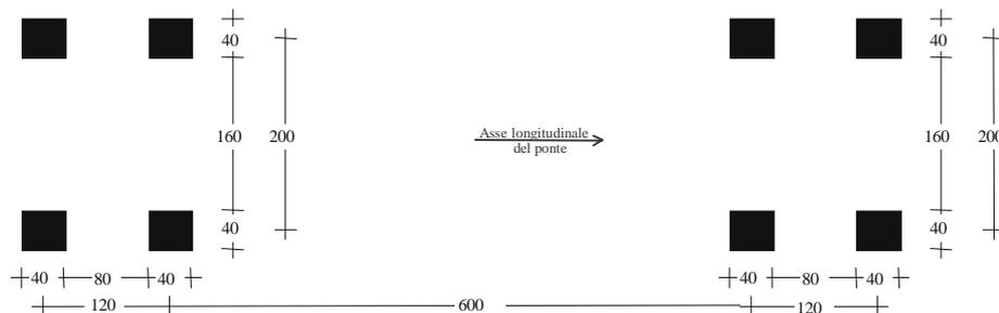
**Figura 5.1.5** – Modello di carico a fatica n. 3
