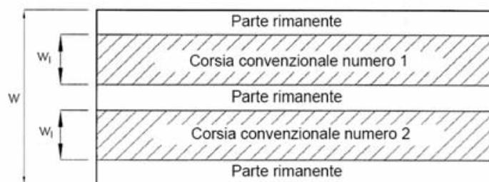
Figura 5.1.1 – Esempio di numerazione delle corsie
