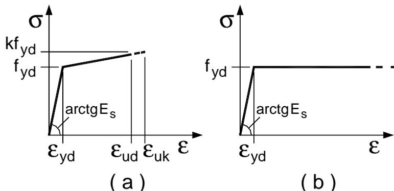
Figura 4.1.2– Modelli  $\sigma$ - $\epsilon$  per l'acciaio
