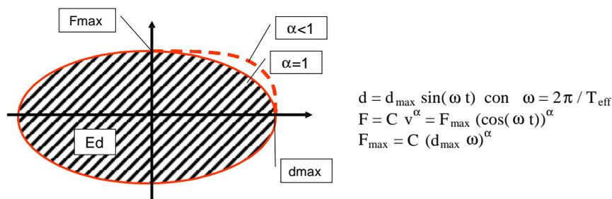
**Figura 11.9.2** – Dispositivi a comportamento viscoso
