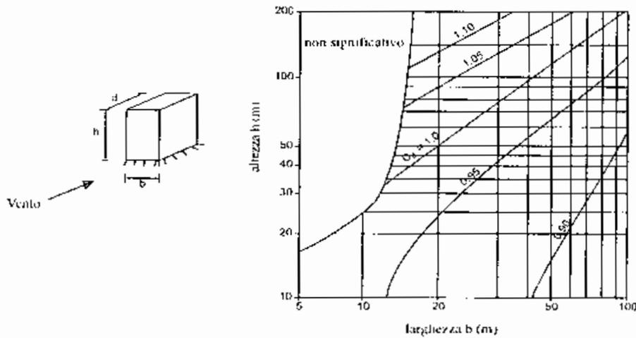
**Figura 3.3.13.b** - Valori del coefficiente dinamico degli edifici a struttura in acciaio
