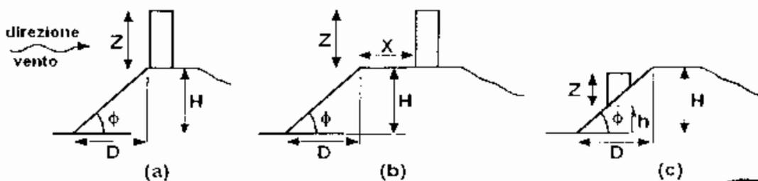
Figura 3.3.5 - Schemi di colline e pendii isolati
