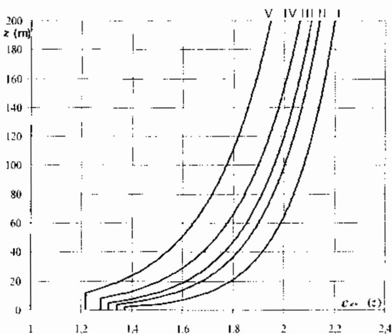
Figura 3.3.4 - Variabilità con altezza e categoria del coefficiente di esposizione delle velocità  $c_w$  quando  $c_s = 1$
