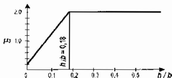
Figura 3.5.8 – Coefficienti di forma per coperture cilindriche
