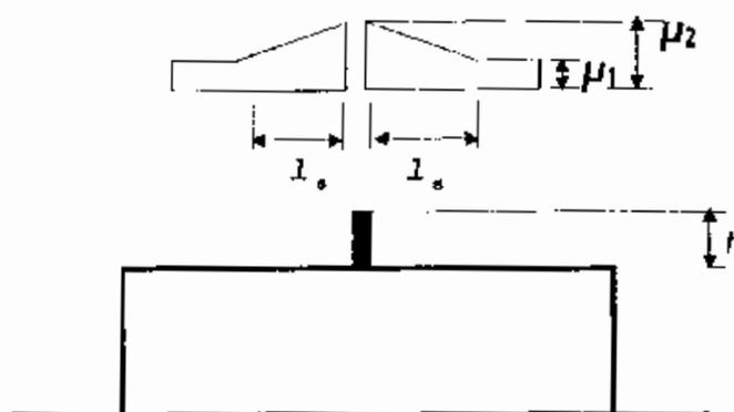
Figura 3.5.10 – Coefficienti di forma in prossimità di parapetti e pareti verticali
