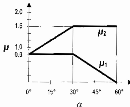
Figura 3.5.3 – Coefficienti di forma per coperture
